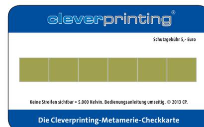
Mithilfe der Cleverprinting-Metamerie-Checkkarte können Sie prüfen, ob eine Lichtquelle zur Betrachtung von Drucksachen geeignet ist. Sehen alle Kästchen gleichmäßig aus, dann ist das Licht geeignet (s. o.). Werden die Kästchen hingegen zweifarbig dargestellt, dann ist die Lichtquelle zur Betrachtung von Drucksachen ungeeignet (s. u.). Die Karte im Format 86 mm x 54 mm können Sie in unserem Onlineshop bestellen
